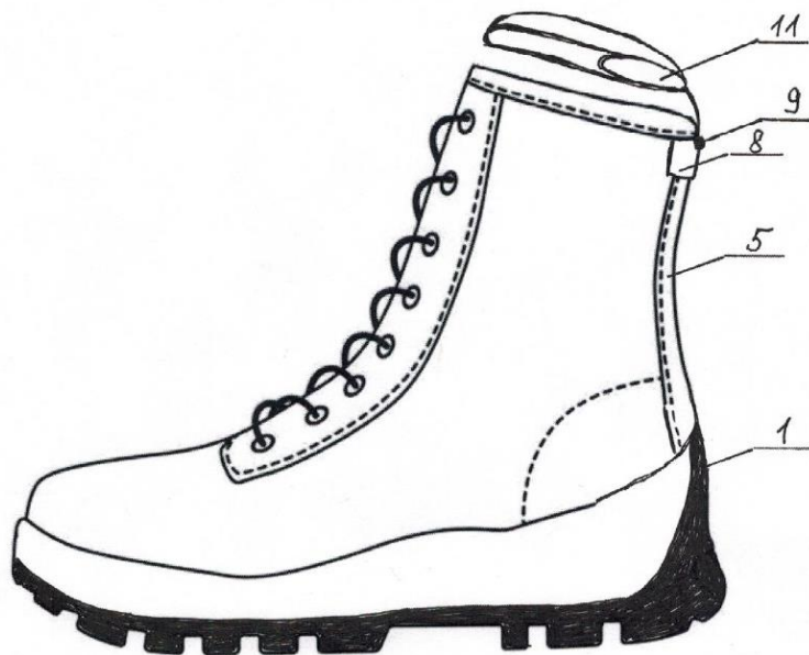
Рисунок 4.37 Устройство антистатической обуви с заземляющими свойствами
